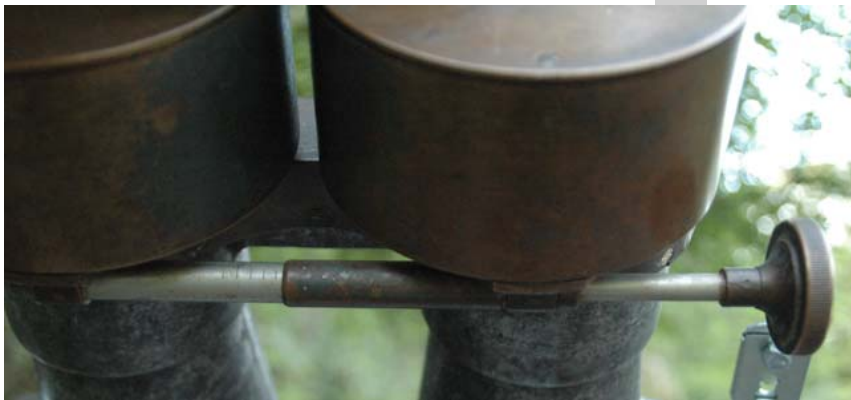
最初期のネジ式目幅調整目盛
